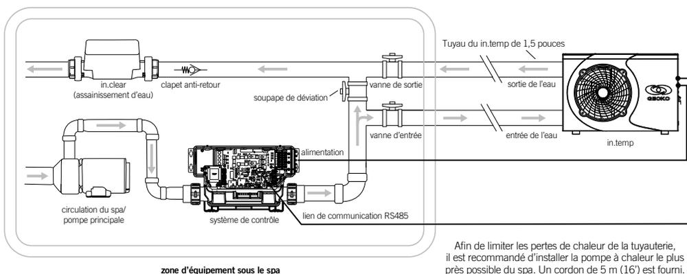
Si votre spa est muni d'un système de traitements des eaux (chlore, brome, sel, etc.), la voie de contournement doit être installée avant le système d'assainissement. Il doit également y avoir une valve anti-retour entre la voie de contournement et le système d'assainissement.
