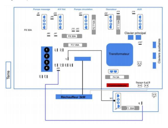
Passez les différents câbles des appareils vers le côté droit du boîtier, et sécurisez-les avec le serre-câble prévu.
