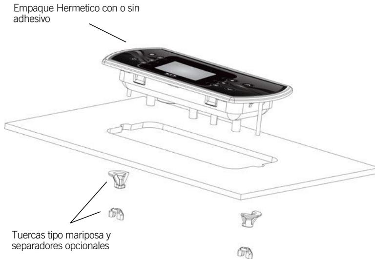
Para instalar el in.k800, use la plantilla de perforación incluida en esta sección. Determine el sitio donde instalará la unidad, adhiera la plantilla en el sitio seleccionado y corte el orificio.
