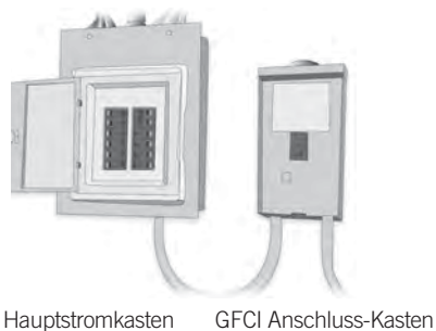
Hauptstromkasten GFCI Anschluss-Kasten
