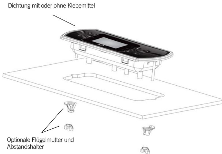
Für die Installation von in.k800 benutzen Sie bitte die beigegefügte Bohrschablone.
