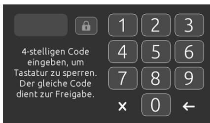
Wenn der Benutzer die Tastatur sperren will, wird er aufgefordert, einen 4-stelligen Code auszuwählen. Der gleiche Code wird benötigt, um die Tastatur zu entsperren.
