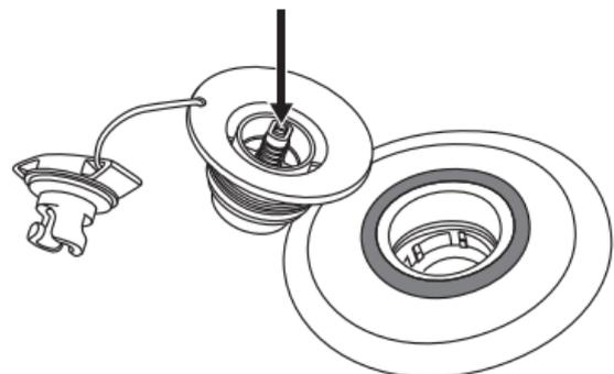
3. Überprüfen Sie den Gummiring, um sicherzustellen, dass er sich in der richtigen Position befindet und fest um das Ventil herum befestigt ist, und prüfen Sie, dass keine Fremdkörper im Weg sind
